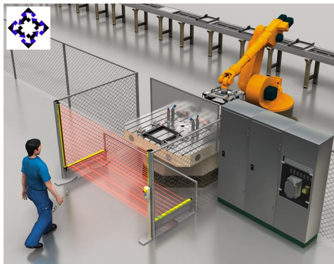
Fig. 7. Celda de manufactura con seguridad funcional
